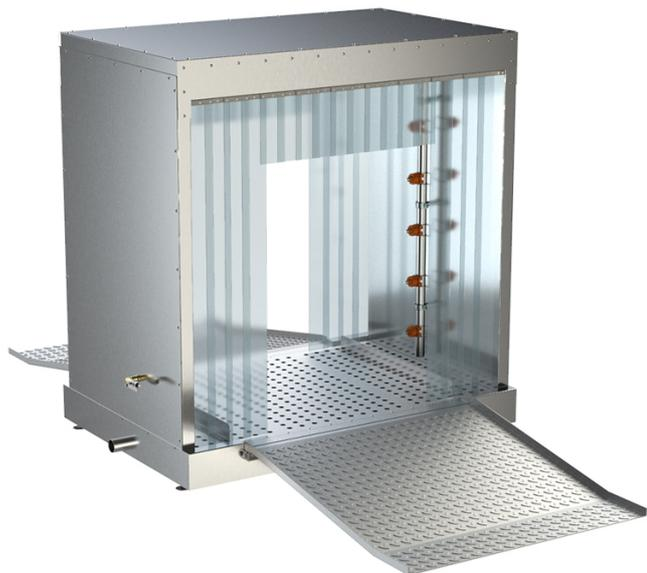
Предназначена для мойки тележек с максимальными размерами 840x1070. Конструкция модуля имеет коллектор с форсунками, подключение воды G1/2, шторки.
