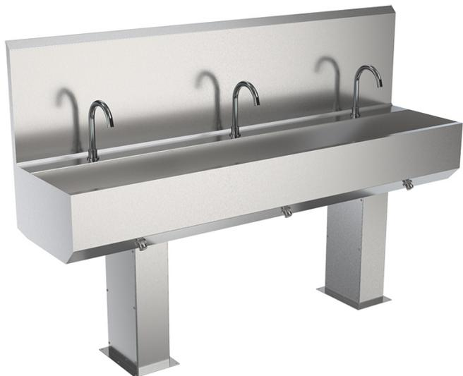
Бесконтактный умывальник БУ-К-023 на 3 поста, с включением коленного типа. Предназначен для мойки рук и инструмента. Подача воды активируется нажатием кнопки коленом. Регулировка температуры и потока воды. Задняя стенка предотвращает затекание воды за умывальник и защищает стену от брызг.
