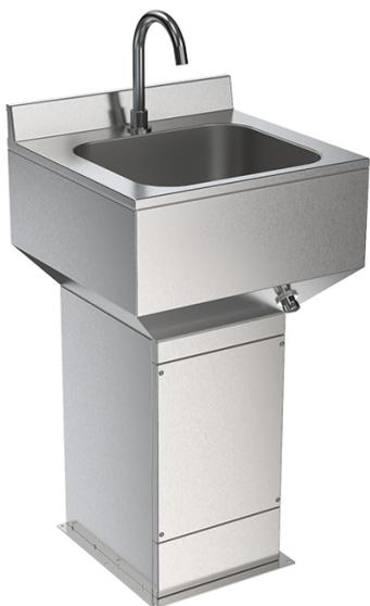
Бесконтактный умывальник БУ-К-011ПД с включением коленного типа напольного исполнения с пьедесталом, закрывающим подводку и сливную трубу расположенных ближе к полу. Подача воды активируется нажатием кнопки коленом. Регулировка температуры и потока воды. Отбортовка предотвращает затекание воды за умывальник.
