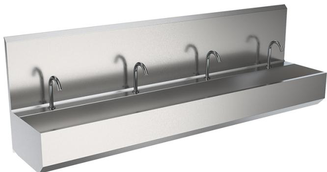
Бесконтактный умывальник БУ-ФН-024 на 4 поста, с включением сенсорного типа. Предназначен для мойки рук и инструмента. Подача воды активируется поднесением рук в зону срабатывания фотодатчика. Регулировка температуры и потока воды. Фильтр для воды входит в комплектацию, он защищает от механических примесей и увеличивает срок работы запорной арматуры, смешивающего блока и излива. Задняя стенка предотвращает затекание воды за умывальник и защищает стену от брызг.
