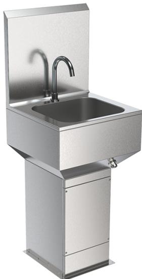
Бесконтактный умывальник БУ-К-021ПД с включением коленного типа напольного исполнения с пьедесталом, закрывающим подводку и сливную трубу, расположенных ближе к полу. Подача воды активируется нажатием кнопки коленом. Регулировка температуры и потока воды. Задняя стенка предотвращает затекание воды за умывальник и защищает стену от брызг.
