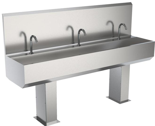
Бесконтактный умывальник БУ-Ф-023 на 3 поста, с включением сенсорного типа. Предназначен для мойки рук и инструмента. Подача воды активируется поднесением рук в зону срабатывания фотодатчика. Регулировка температуры и потока воды. Фильтр для воды входит в комплектацию, он защищает от механических примесей и увеличивает срок работы запорной арматуры, смешивающего блока и излива. Задняя стенка предотвращает затекание воды за умывальник и защищает стену от брызг.
