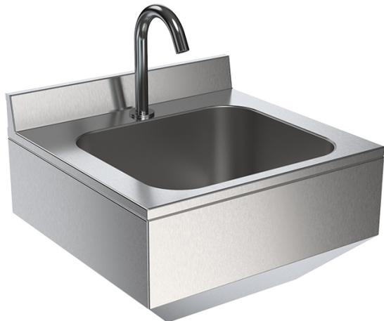
Бесконтактный умывальник БУ-ФН-011 с включением сенсорного типа предназначен для мойки рук и инструмента. Подача воды активируется поднесением рук в зону срабатывания фотодатчика. Регулировка температуры и потока воды. Фильтр для воды входит в комплектацию, он защищает от механических примесей и увеличивает срок работы запорной арматуры, смешивающего блока и излива. Отбортовка предотвращает затекание воды за умывальник.
