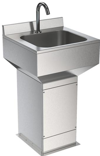
Бесконтактный умывальник БУ-Ф-011ПД с включением сенсорного типа предназначен для мойки рук и инструмента. Подача воды активируется поднесением рук в зону срабатывания фотодатчика. Регулировка температуры и потока воды. Фильтр для воды входит в комплектацию, он защищает от механических примесей и увеличивает срок работы запорной арматуры, смешивающего блока и излива. Отбортовка предотвращает затекание воды за умывальник.
