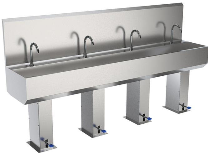
Бесконтактный умывальник БУ-П-024 на 4 поста, с включением педального типа предназначен для мойки рук и инструмента. Подача воды активируется нажатием ногой на педаль. Регулировка температуры и потока воды. Задняя стенка предотвращает затекание воды за умывальник и защищает стену от брызг.
