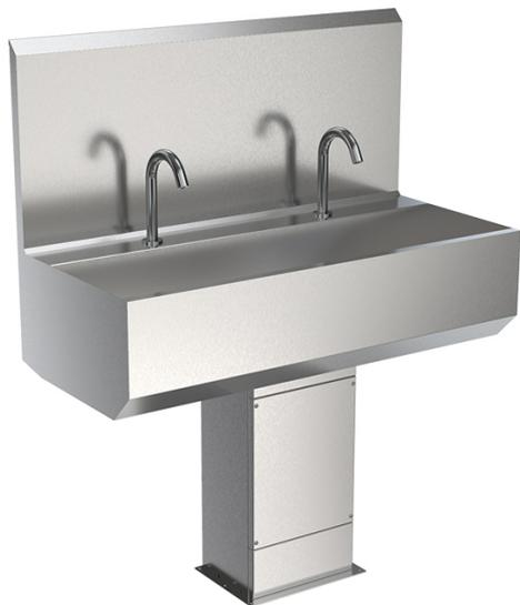
Бесконтактный умывальник БУ-Ф-022 на 2 поста, с включением сенсорного типа. Предназначен для мойки рук и инструмента. Подача воды активируется поднесением рук в зону срабатывания фотодатчика. Регулировка температуры и потока воды. Фильтр для воды входит в комплектацию, он защищает от механических примесей и увеличивает срок работы запорной арматуры, смешивающего блока и излива. Задняя стенка предотвращает затекание воды за умывальник и защищает стену от брызг.
