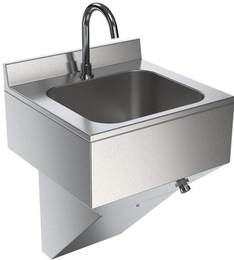
Бесконтактный умывальник БУ-КН-011ПП с включением коленного типа настенного исполнения с полупьедесталом, закрывающим подводу и сливную трубу расположенных в стене. Подача воды активируется нажатием кнопки коленом. Регулировка температуры и потока воды. Отбортовка предотвращает затекание воды за умывальник.
