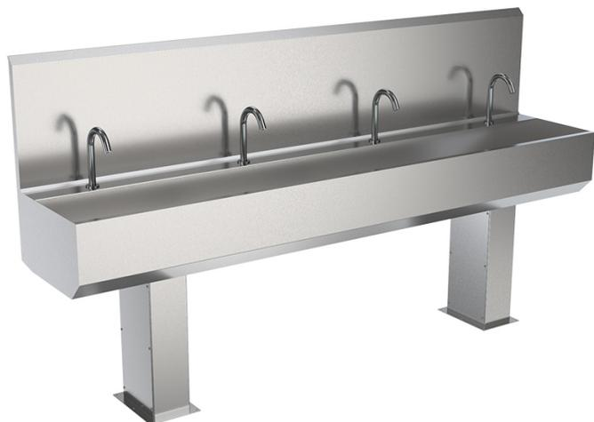
Бесконтактный умывальник БУ-Ф-024 на 4 поста, с включением сенсорного типа. Предназначен для мойки рук и инструмента. Подача воды активируется поднесением рук в зону срабатывания фотодатчика. Регулировка температуры и потока воды. Фильтр для воды входит в комплектацию, он защищает от механических примесей и увеличивает срок работы запорной арматуры, смешивающего блока и излива. Задняя стенка предотвращает затекание воды за умывальник и защищает стену от брызг.
