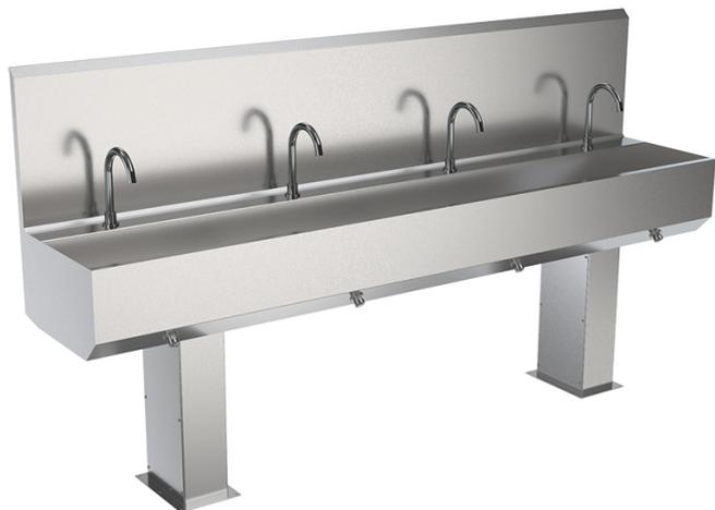
Бесконтактный умывальник БУ-К-024 на 4 поста, с включением коленного типа. Предназначен для мойки рук и инструмента. Подача воды активируется нажатием кнопки коленом. Регулировка температуры и потока воды. Задняя стенка предотвращает затекание воды за умывальник и защищает стену от брызг.
