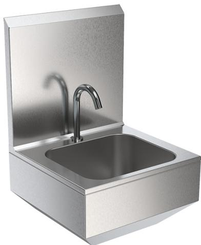
Бесконтактный умывальник БУ-ФН-021 с включением сенсорного типа настенного исполнения предназначен для мойки рук и инструмента. Подача воды активируется поднесением рук в зону срабатывания фотодатчика. Регулировка температуры и потока воды. Фильтр для воды входит в комплектацию, он защищает от механических примесей и увеличивает срок работы запорной арматуры, смешивающего блока и излива. Задняя стенка предотвращает затекание воды за умывальник, и защищает стену от брызг.
