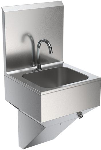
Бесконтактный умывальник БУ-КН-021ПП с включением коленного типа настенного исполнения с полупьедесталом, закрывающим подводу и сливную трубу расположенных в стене. Подача воды активируется нажатием кнопки коленом. Регулировка температуры и потока воды. Задняя стенка предотвращает затекание воды за умывальник и защищает стену от брызг.
