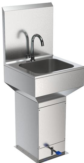
Бесконтактный умывальник БУ-П-021ПД с включением педального типа предназначен для мойки рук и инструмента. Подача воды активируется нажатием ногой на педаль. Регулировка температуры и потока воды. Задняя стенка предотвращает затекание воды за умывальник и защищает стену от брызг.
