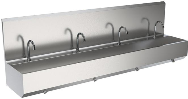
Бесконтактный навесной умывальник БУ-КН-024 на 4 поста, с включением коленного типа. Предназначен для мойки рук и инструмента. Подача воды активируется нажатием кнопки коленом. Регулировка температуры и потока воды. Задняя стенка предотвращает затекание воды за умывальник и защищает стену от брызг.
