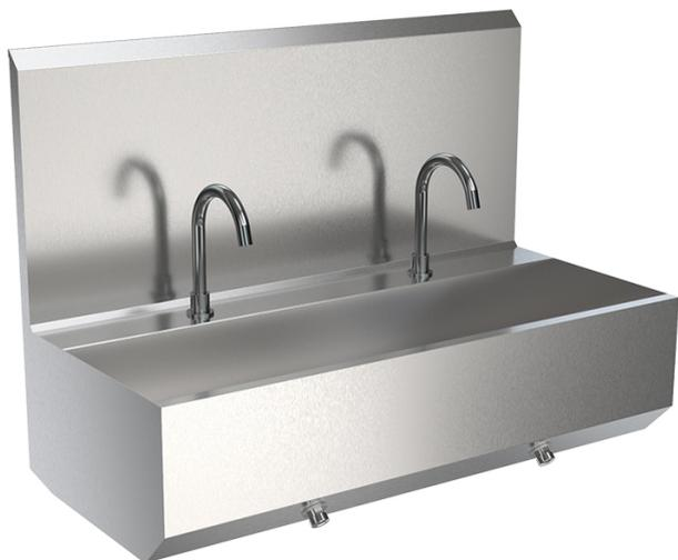
Бесконтактный навесной умывальник БУ-КН-022 на 2 поста, с включением коленного типа. Предназначен для мойки рук и инструмента. Подача воды активируется нажатием кнопки коленом. Регулировка температуры и потока воды. Задняя стенка предотвращает затекание воды за умывальник и защищает стену от брызг.
