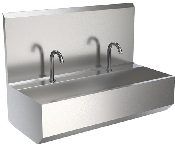
Бесконтактный умывальник БУ-ФН-022 на 2 поста, с включением сенсорного типа. Предназначен для мойки рук и инструмента. Подача воды активируется поднесением рук в зону срабатывания фотодатчика. Регулировка температуры и потока воды. Фильтр для воды входит в комплектацию, он защищает от механических примесей и увеличивает срок работы запорной арматуры, смешивающего блока и излива. Задняя стенка предотвращает затекание воды за умывальник и защищает стену от брызг.
