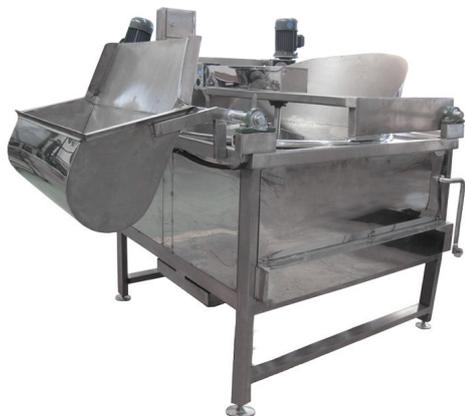
Полностью автоматическое ошпаривание и ощипывание тушек птиц. Оснащена автоматическим перемешиванием, электронагревом с регулятором температуры, выгрузкой, воздушным насосом и функцией обескровливания.
