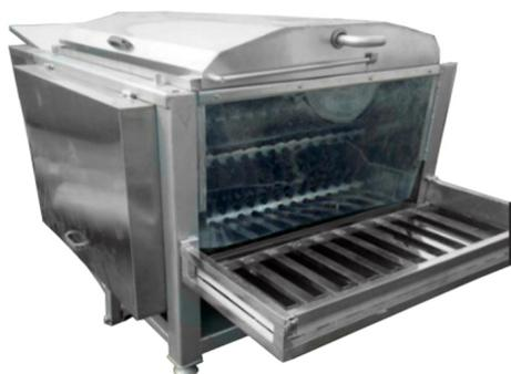
Машина предназначена для ошипывания тушек птиц.
