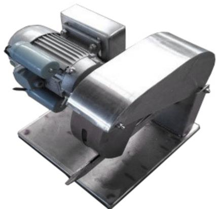
Предназначена для разделения тушек битой охлажденной птицы на части при производстве полуфабрикатов.
