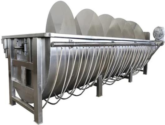
Шнековая машина предварительного охлаждения, использующая перемешивание воздушным потоком под высоким давлением и метод выдвижения винтовых лопастей вперед для равномерного охлаждения цыплят и придания им лучшего вкуса.
