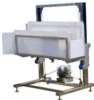
Машина предназначена для электрооглушения птицы.
