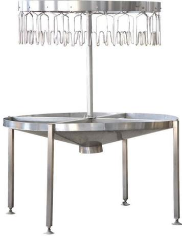
Предназначен для разделки птицы. Оснащен вешалами и резервуаром для сбора потрохов.
