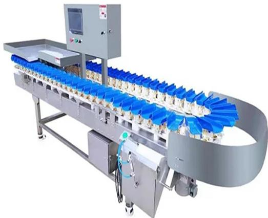
Автоматическая весовая сортировочная машина имеет широкий спектр применений, обеспечивает точную сортировку и простоту в эксплуатации. Она широко используется в процессе пищевой промышленности для упаковки, включая забой цыплят или переработку птицы.
