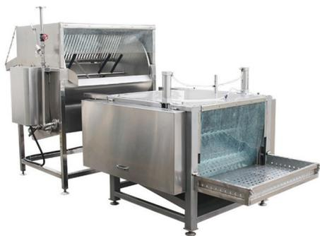
Полностью автоматическое оборудование для ошпаривания и ощипывания тушек птиц. Оснащена автоматическим перемешиванием, электронагревом с регулятором температуры, выгрузкой и воздушным насосом.
